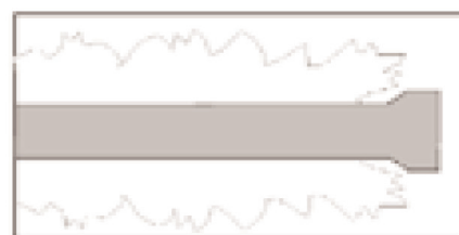
Combustion défectueuse: Flammes jaunes, instables (trop peu d'air)
